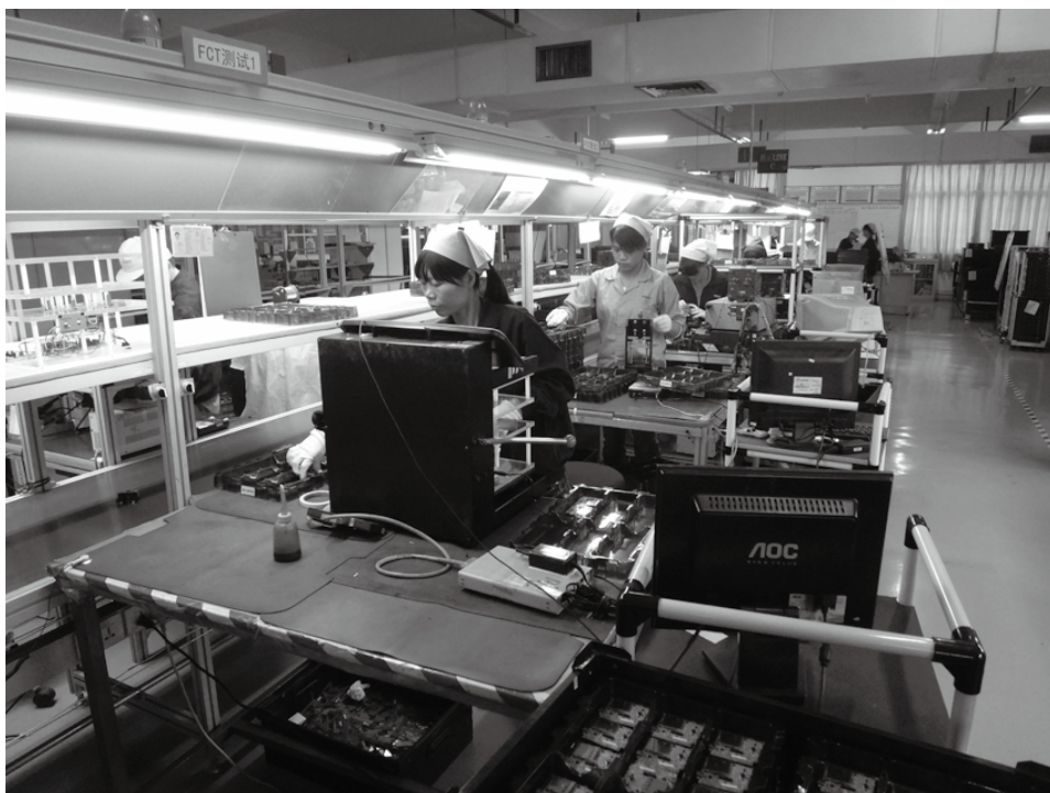
図12 ティアック社の海外量産現場で稼働しているJTAGバウンダリスキャンテストシステム
