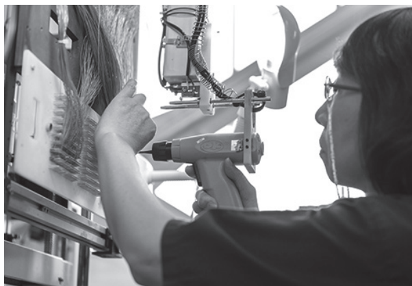
図13 半自動配線機によるラッピング作業
